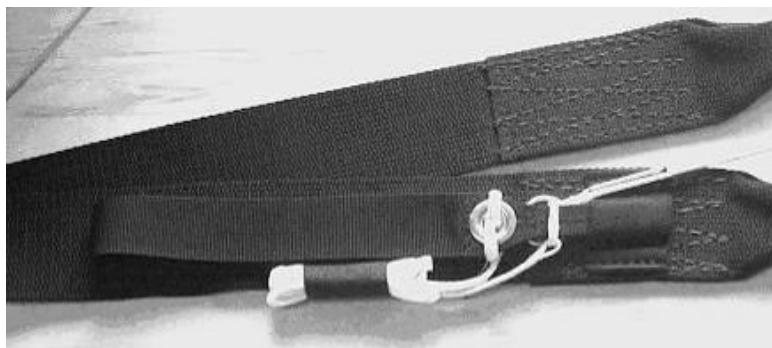
Zapojení volného konce nosného postroje hlavního padáku do postroje
