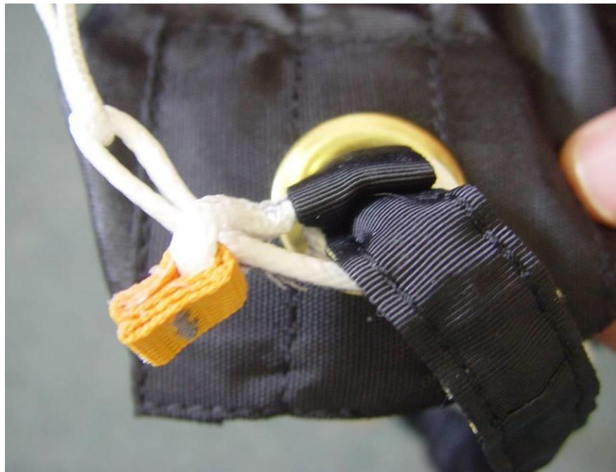
Volným koncovým očkem protáhněte opačný konec „soft linku“ s lemovkou a toto spojení utáhněte tak, aby spojení bylo dostatečně pevné. Takto vytvořený spoj utáhněte tahem za spojovací lemovku výtažného padáku a za vak vrchlíku hlavního padáku.
