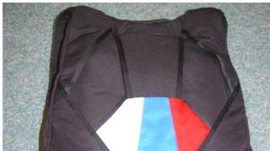
Po uzavření obalového dílce záložního padáku provedeme zaplobmování uzavírací jehly ručního uvolňovače záložního padáku a balení zapíšeme do padákového záznamníku.
